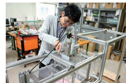
フィルム冷却の風洞試験
