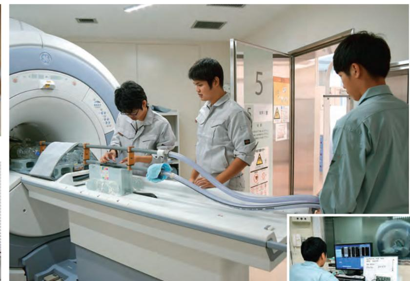
総合大学だからできる保健福祉学部との協同研究(MRIを用いた3次元冷却流路の流速分布測定)
